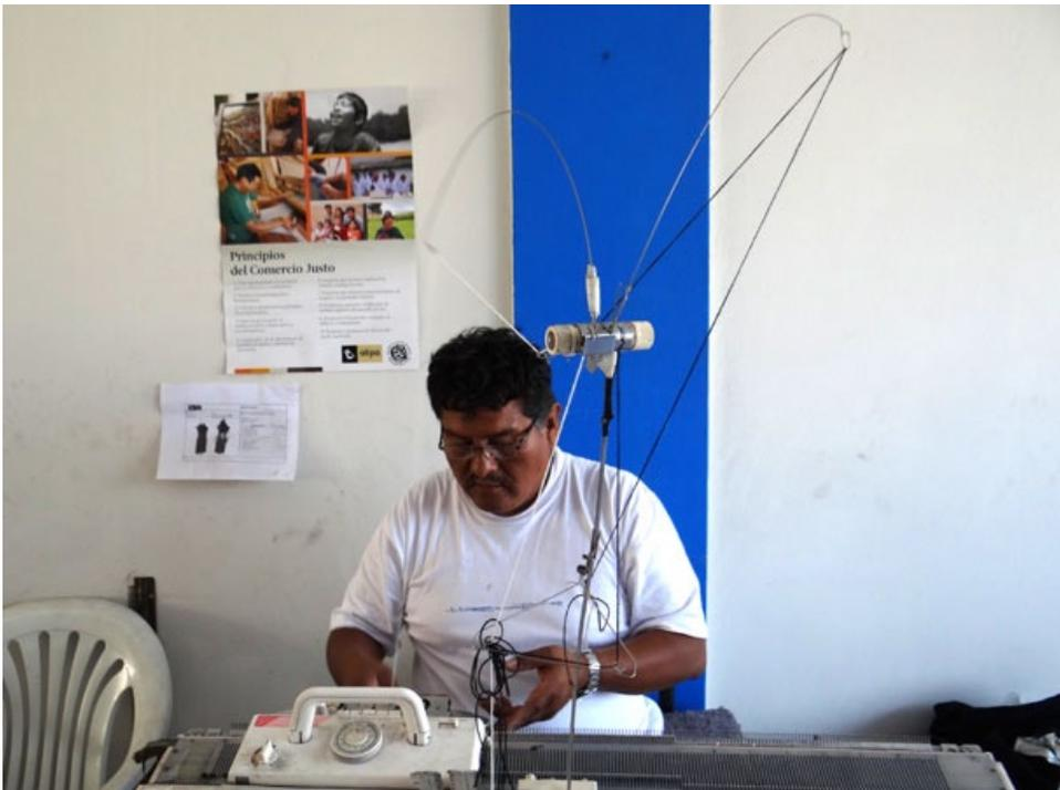
Geduldig und mit viel Passion erklärt uns Juan seine Handstrickmaschine. Extra für uns fädelt er den Faden durch die unzähligen Ösen und demonstriert uns die verschiedenen Stricktechniken. Die Maschine besteht aus zwei Strickköpfen, je nach Muster werden der Obere, der Untere, oder Beide gleichzeitig benutzt.
